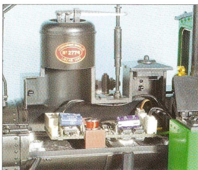
Decoder für den problemlosen Einbau in LGB-Loks von Massoth
