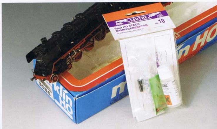
Der klassische Fall: Eine Märklin-Lok soll mit einem Rauchgenerator nachgerüstet werden. Zur 3085 passt Seuthes #10.
